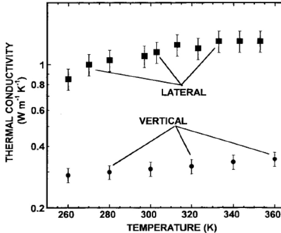
2.25  $\mu\text{m}$  Du Pont PI 2556, BTDA-ODA-MPD
